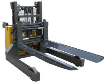
Hochhubwagen für den Transport von Rollen und Trommel in den Ttagkraftklassen von 1,0 bis 10 t.
