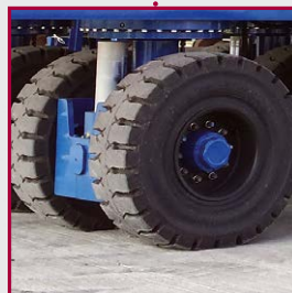
Hubeinheit, selbst ausgleichend mit 90° Lenk-System (patentiert)
